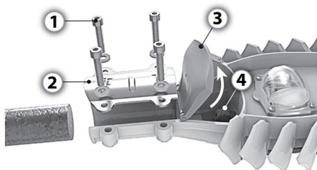
Для улучшения вентиляции радиаторов и функционирования системы самоочистки угол установки светильника должен быть от 15° до 75°
